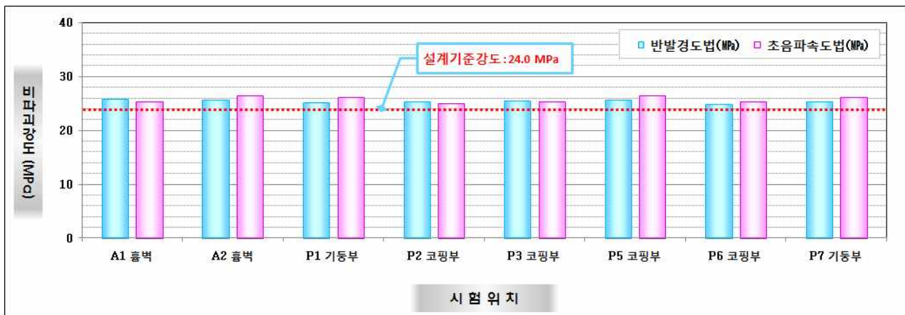
【그림 3.4.12】하부구조(교대, 교각) 평균압축강도 추정결과(대구)
