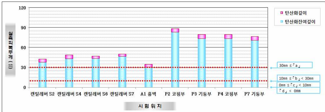
【그림 3.4.17】 탄산화 깊이 측정결과(부산)
