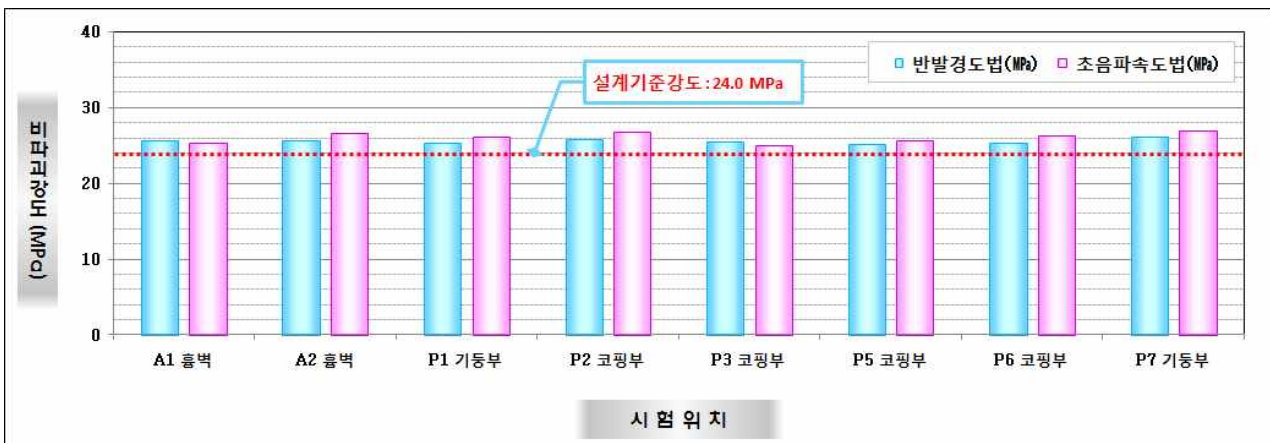
【그림 3.4.16】하부구조(교대, 교각) 평균압축강도 추정결과(부산)
